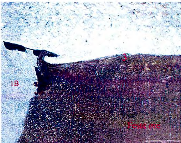
Fig 5. Nærbilde: Sveis 3, friksjonssveis og sveis 1B, smeltesveis, med rotfeil. Stålet i feste øret inneholder mye karbon, men det er ikke dannet martensitt ifm sveisingen; tyder på før- og/eller ettervarming. Noe Widmannstättten-ferritt ble funnet i HAZ mot smelten i sveis 1 A & B.
