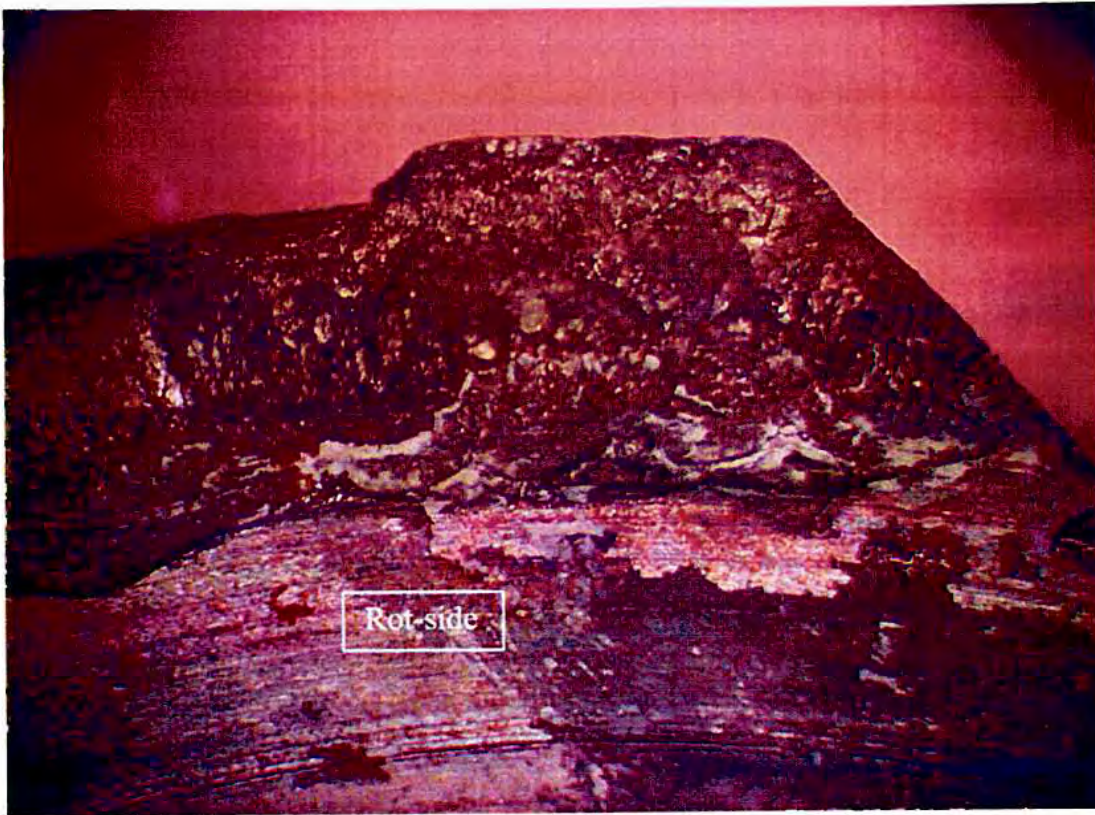
Fig 4. Bilde av bruddflaten til sveis B nær den usveiste tverrflaten. Rester av maling på bruddflaten på rot-siden. Malingsrestene fortoner seg hvite.
