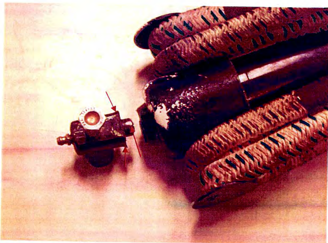
Fig 1. Oversiktsbilde av innlevert demper PA-25 med brudd i sveiseforbindelser. Sveiseforbindelsene med brudd er antydnet med piler.
