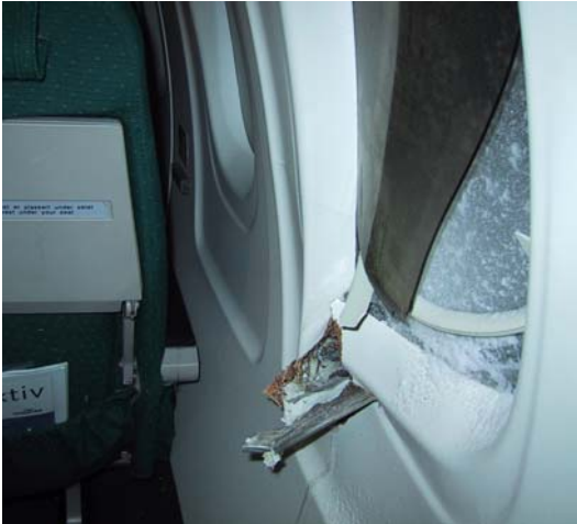
Fig. 9a Propellfragmentet inne i kabinen
