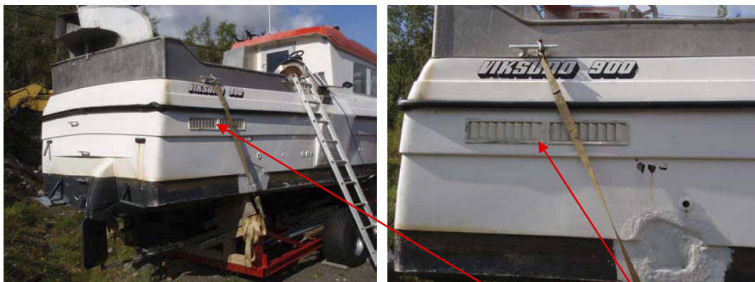
Figur 10: Luftinntak til motor på Marina.
