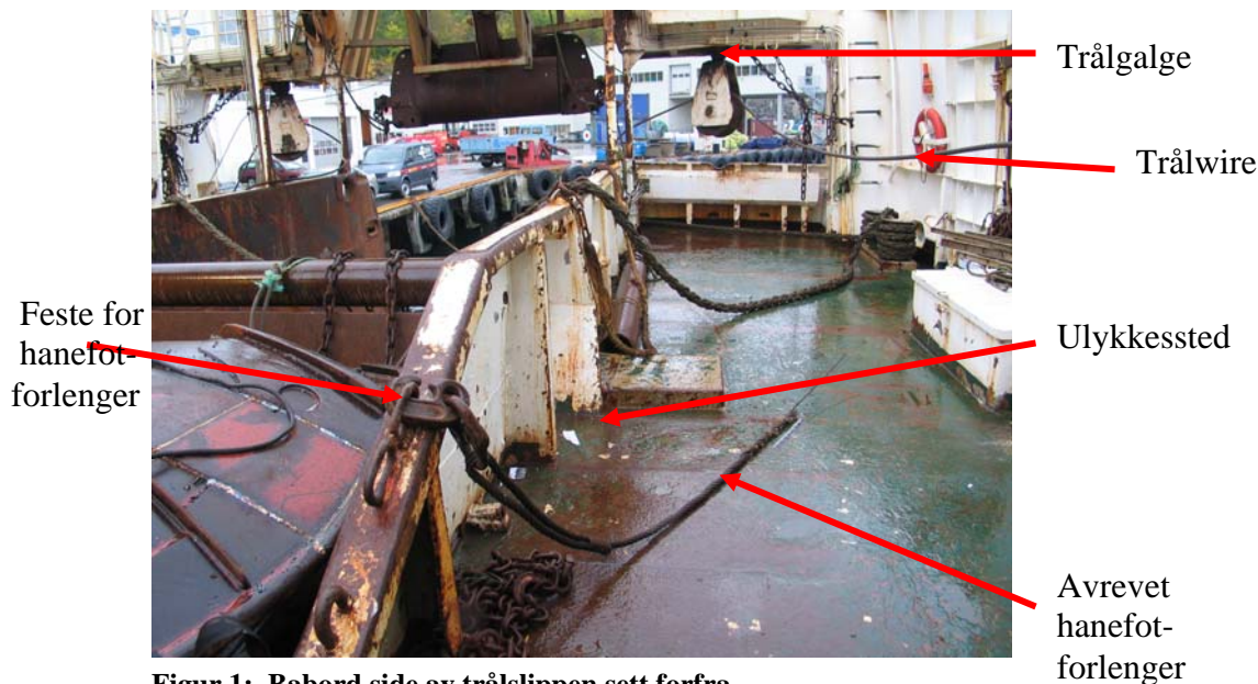
Figur 1: Babord side av trålslippen sett forfra.
