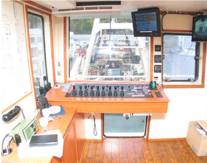
Figur 5: Betjeningspanel akter i styrehus.
