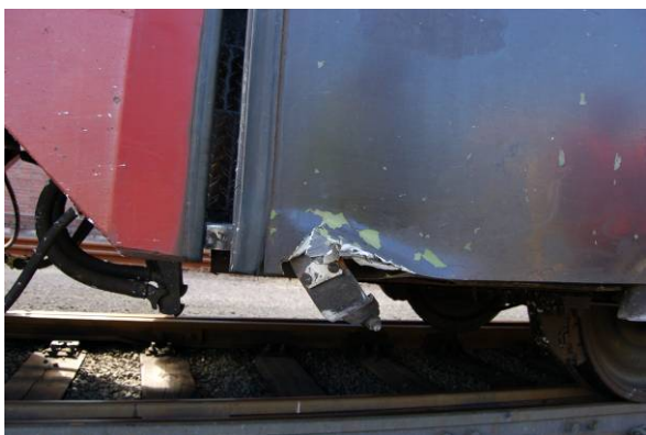
Figur 5. viser skader på nedre dørføring.
