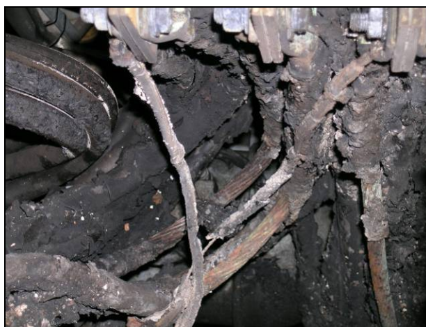
Figur 5 Detaljbilde av utbrente kabler. Koblingsklemmene sees i bildets overkant
