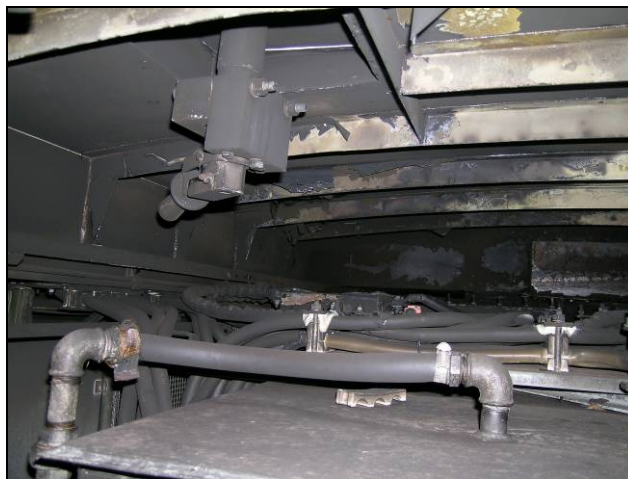
Figur 3 Det var brannskader på toppen av hovedtransformatoren, samt store sotskader i hele taket innvendig i lokomotivet.
