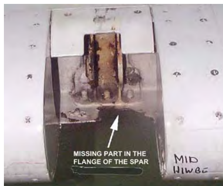
Fig. 7b Skade på hovedbjelkens flens ved midtre hengslepunkt
