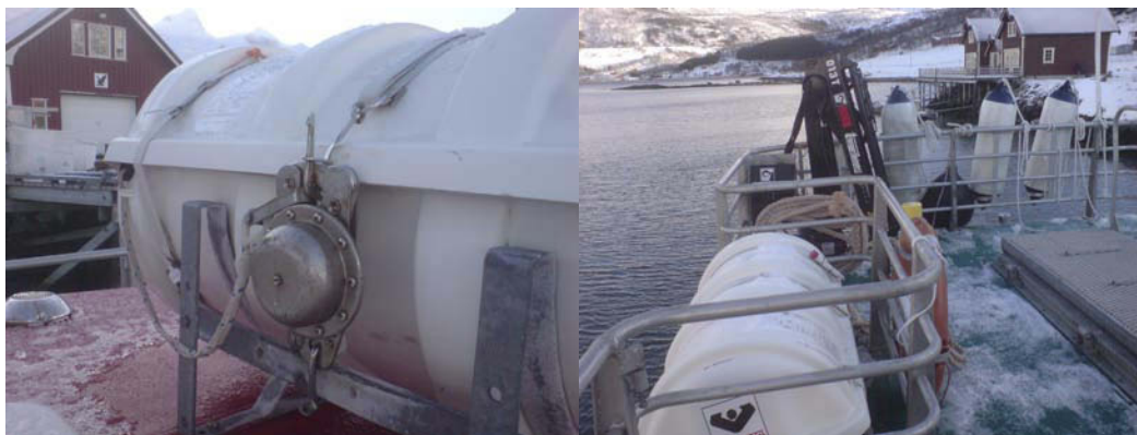
Figur 10: Redningsflåte med hydrostatisk utløser (Bildet fra søsterfartøy).
