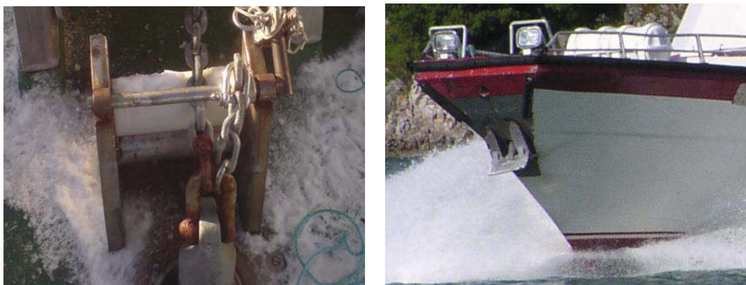
Figur 8: Utløsermekanisme for ankeret.
