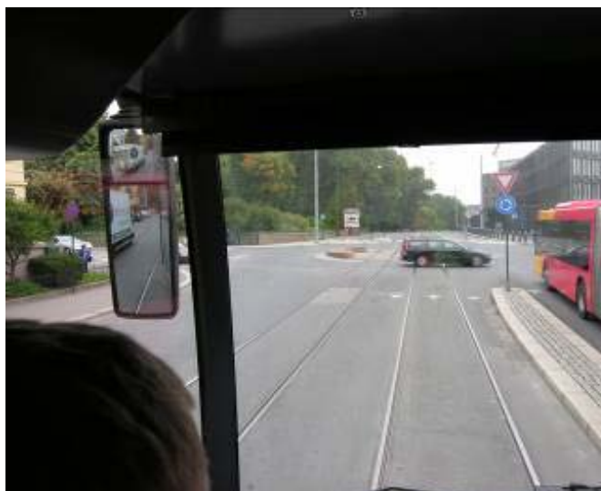
Figur 14: Siktsoner fra førerposisjon i tilsvarende trikk inn mot rundkjøringen. Vindusstolpe og sidespeil utgjør en blindsonesektor for vognfører.
