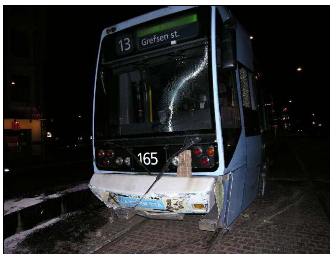
Figur 5: Skader i fronten på trikken.
