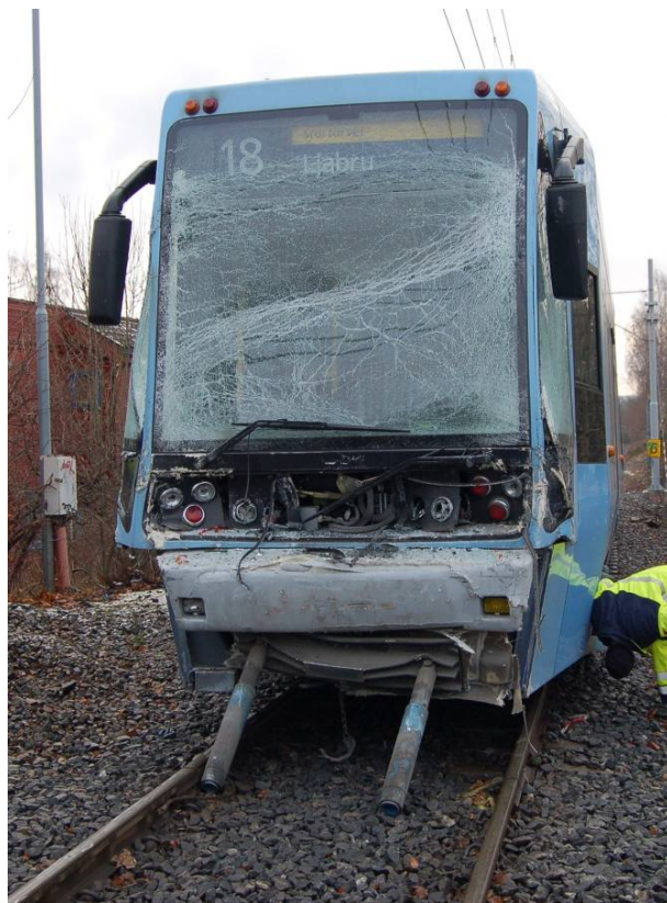
Figur 3: Bakre enden på vogn 166 etter sammenstøtet.
