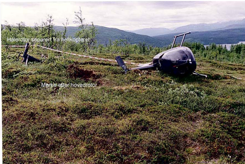
Figur 1: Helikopteret liggende på til høyre side, mot terrenghellingen med spor etter hovedrotorblad i torva og med halerotor liggende bak helikoptervraket. Takvatnet i Bakgrunnen.
