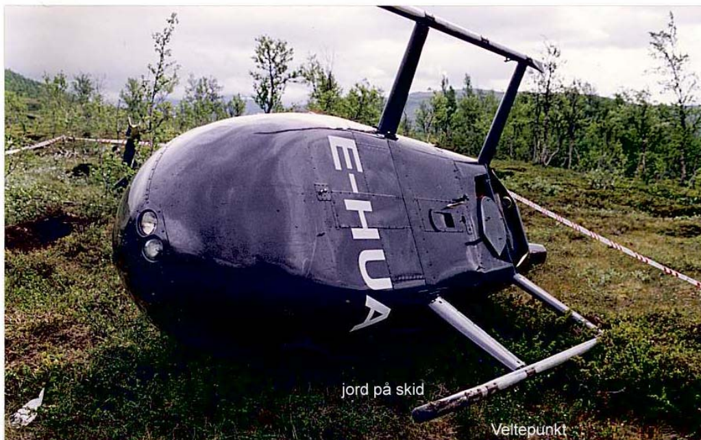
Figur 2: Helikopteret på siden med merke i bakken etter høyre skid, og høyre skid er dekket av et lag med jord.
