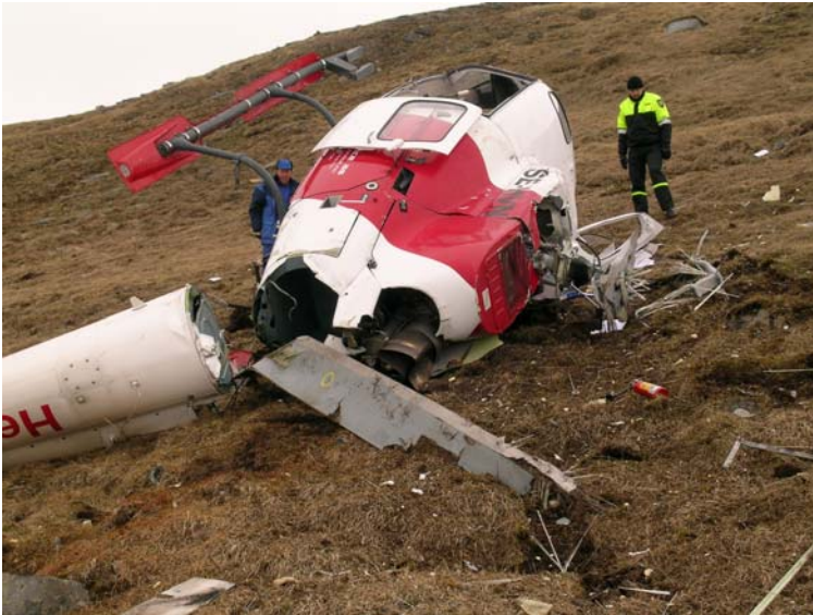
Fig. 1 SE-HVN slik det ble liggende etter havariet. Merker etter brann og rotorblader er tydelige.
