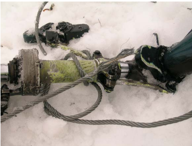
Fig. 2 Halerotor med gearboks og wire. Wire med svivel og krok var begravd dypt ned i snøen under rotor/gearbokskomponentene.
