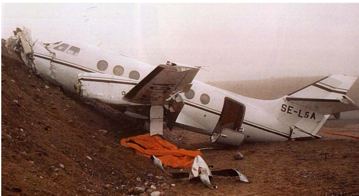
Bilde tatt mot syd dagen etter ulykken. Legg merke til vridningen av vingen, motoren og understellet
