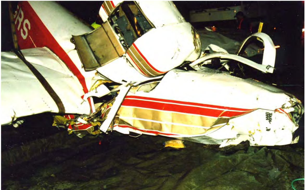
Bildet viser skadene i fronten og at motoren har slått ned i cockpit
