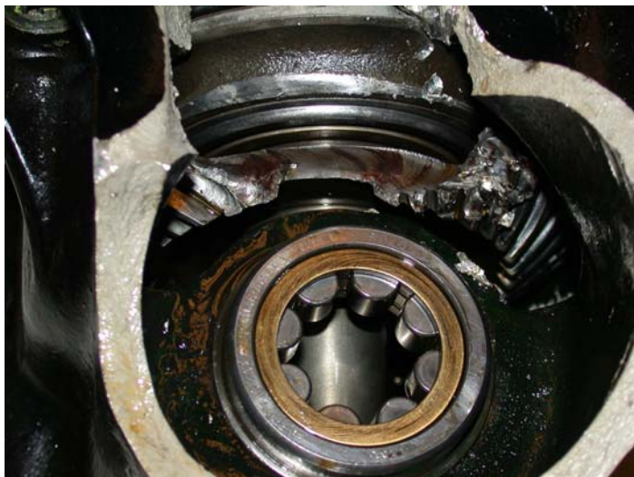
Figur 2 Bilde av tannhjul med bruddskade som observert i inntakssiden av girboksen ref. Figur 1.
