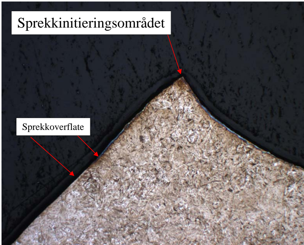
Figur 10 Representativt bilde av tverrslip inn mot sprekkinitieringsområdet.
