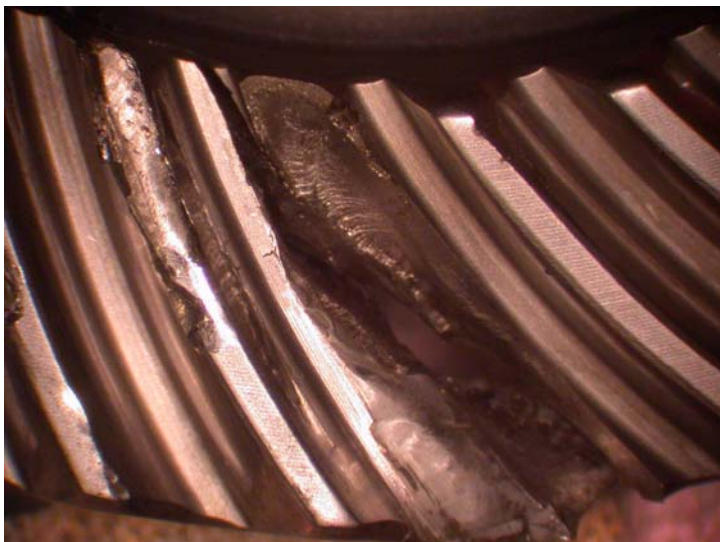
Figur 5 Bilde av separert bit satt inn mot tannhjulet. Viser at en tann mangler.
