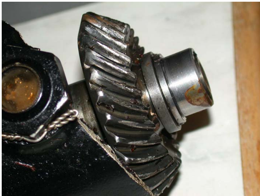
Figur 3 Oversiktsbilde av tannhjul på uttakssiden. Undersøkelse i stereomikroskop konkluderte at de observerte skadene var sekundærskader.
