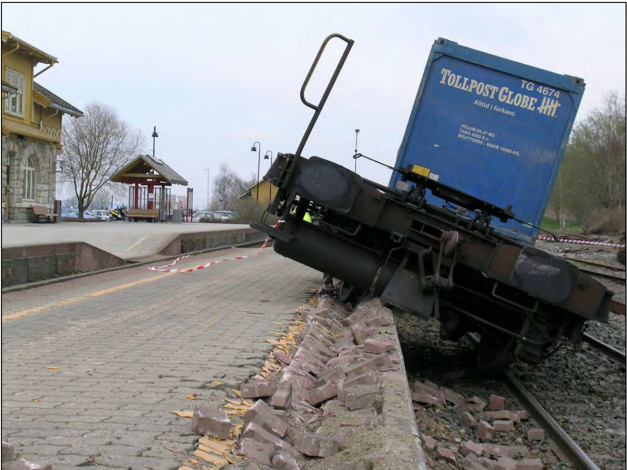
Figur 1: Viser avsporet vogn som ble trukket over plattformen mellom spor 1 og 2.
