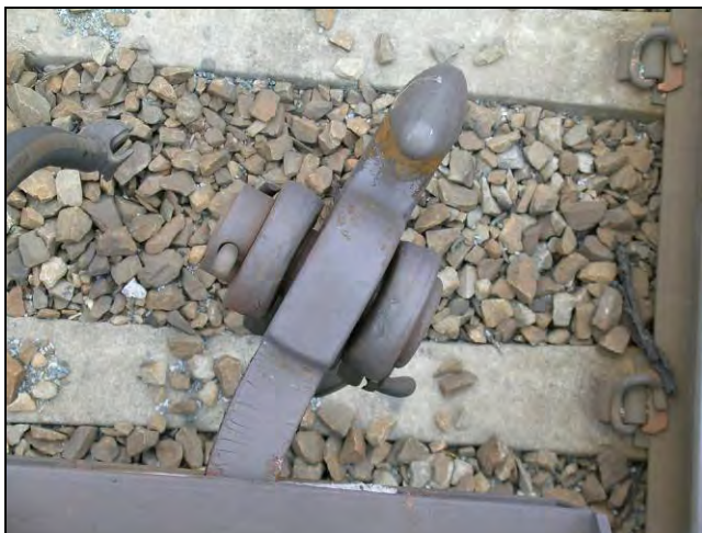
Figur 5: Koblingskroken ble bøyd på den siste vognen som stanset i spor 1.
