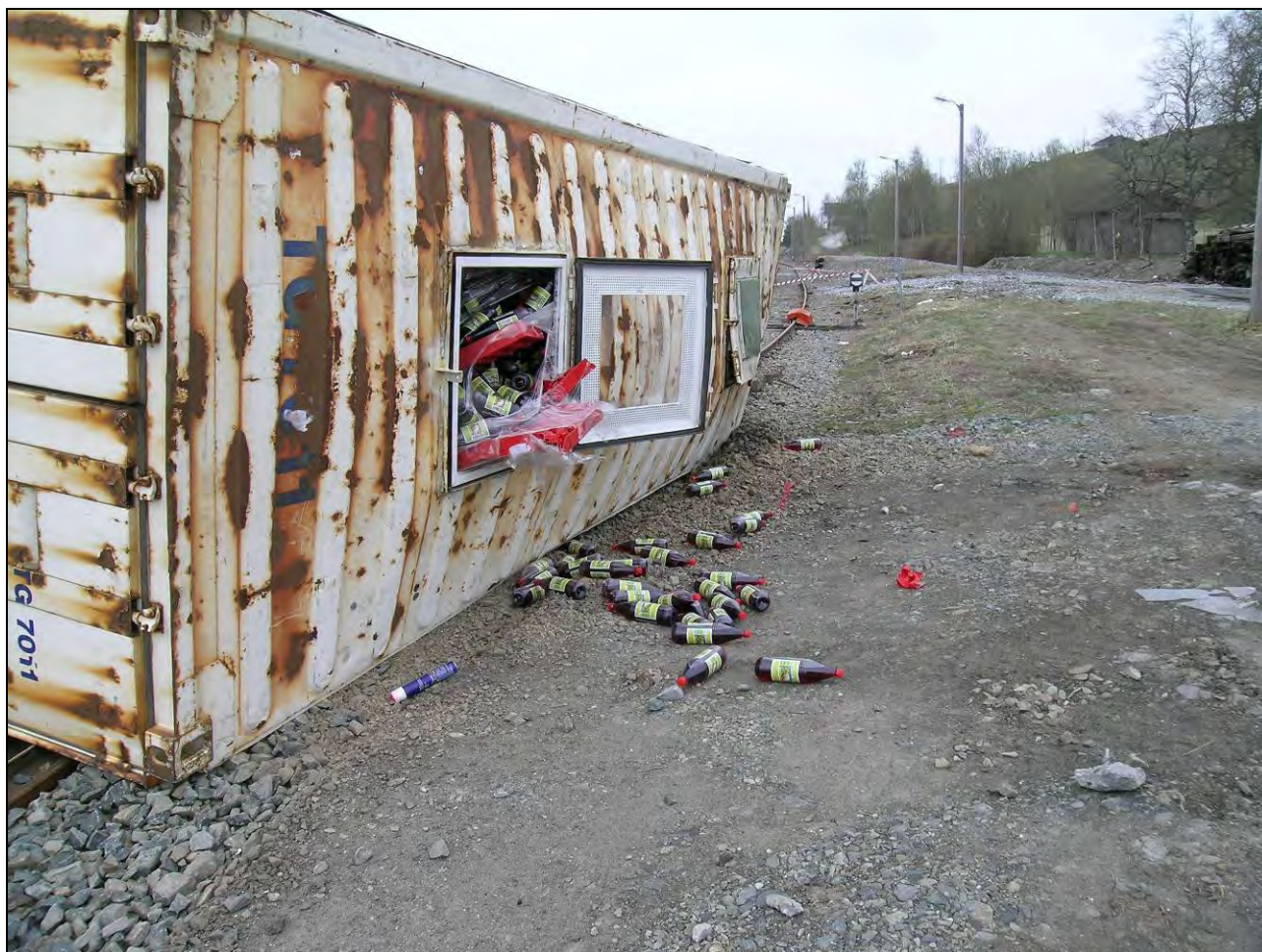
Figur 8: Viser skader på containeren som falt av og deler av lasten som falt ut.
