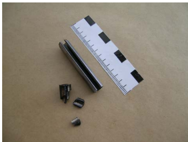
Figur 3 viser spennstift (spennhylse) samt rester av den defekte
