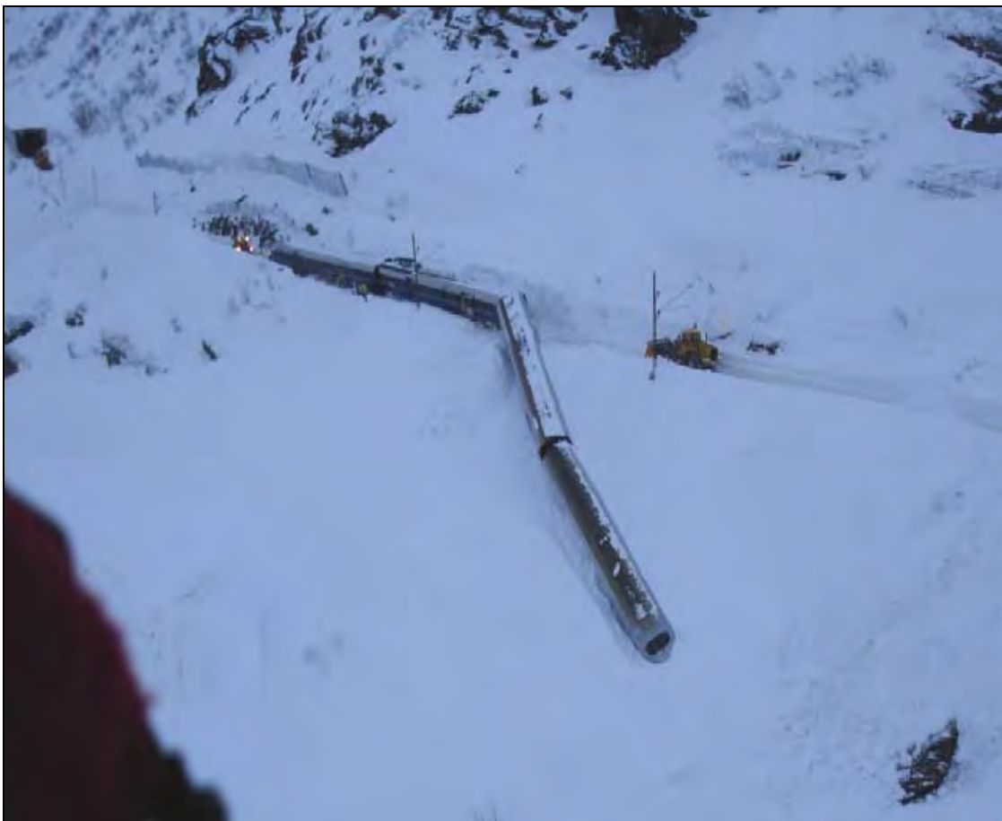
Figur 10: Viser det avsporede togsettet etter at det bakre togsettet hadde blitt fjernet. På bildet sees også de to KL-mastene som toget kjørte ut mellom.
