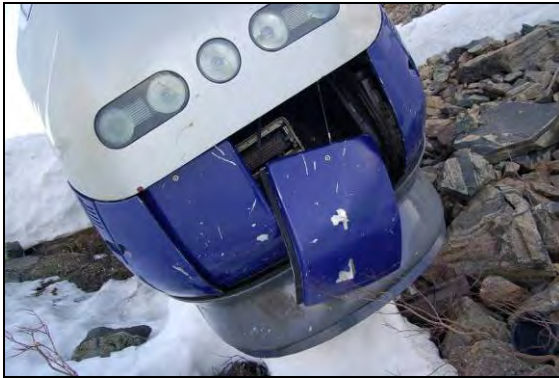
Figur 12: Fronten på togsett 73007 viser de to lukene som ble slått inn under sammenstøtet med snøskredet.
