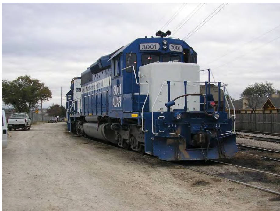
Figur 8 Eksempel på typisk Nordamerikansk diesellokomotiv (type SD40-2). Løsning på plog er tilnærmet lik på alle senere lokomotiv fra EMD eller GE.
