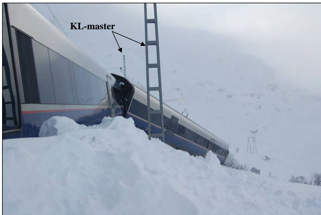
Figur 3: Toget sporet av og kjørte ut mellom to KL-master uten å skade disse.
