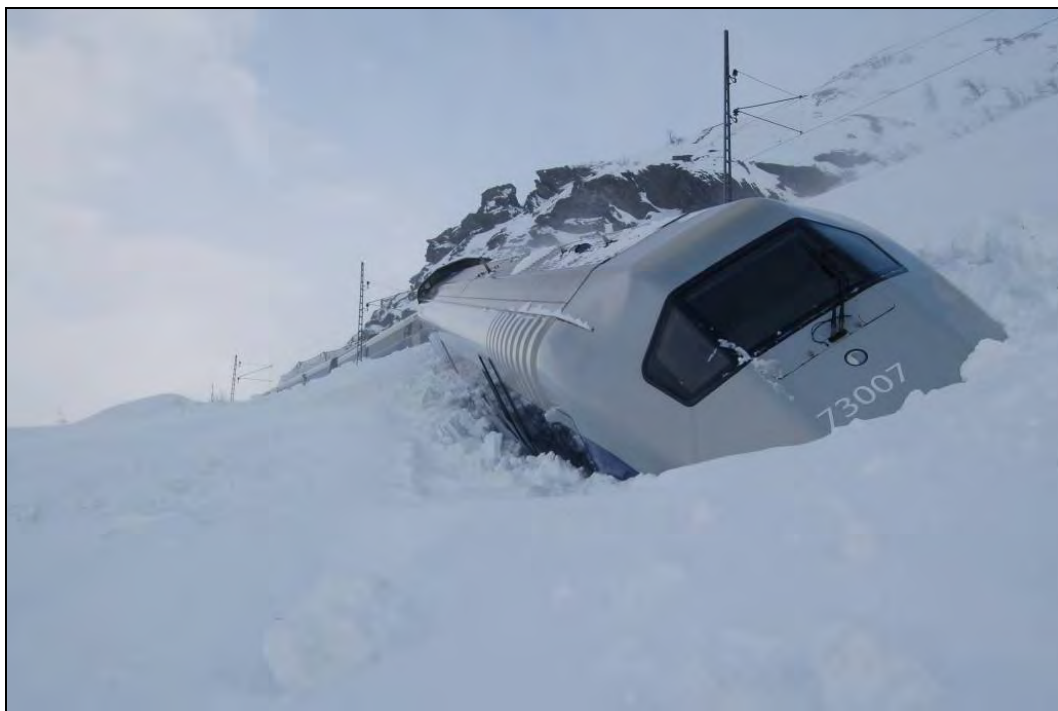
Figur 2: Togets 2 fremste vogner sporet av og havnet utenfor sporet.
