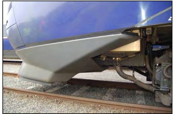
Figur 13: Avstanden fra frontskjørt og ned til skinnen er ca 20 cm. Et jern er festet i underkant av frontskjørtet.
