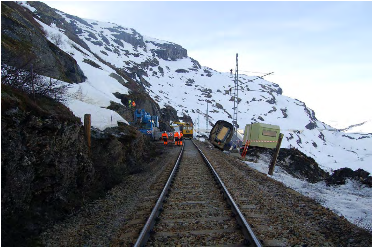
Figur 11 avsporing skjedde på tilnærmet rett spor
