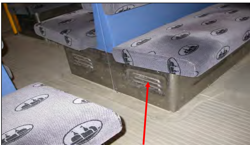
Figur 21: Bilde som viser hvor varmluft kommer opp fra kjørebremsemotstand og inn i passasjerrommet på vogner type T1000 og T1300.
