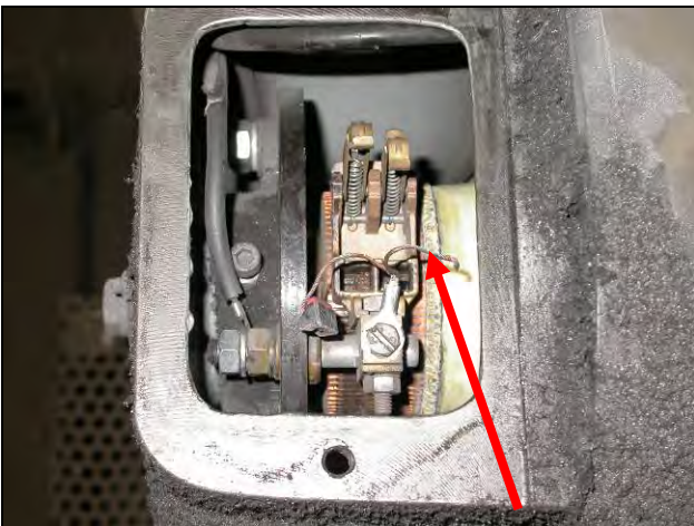
Figur 15: Bilde av viftemotor med manglende børster.
