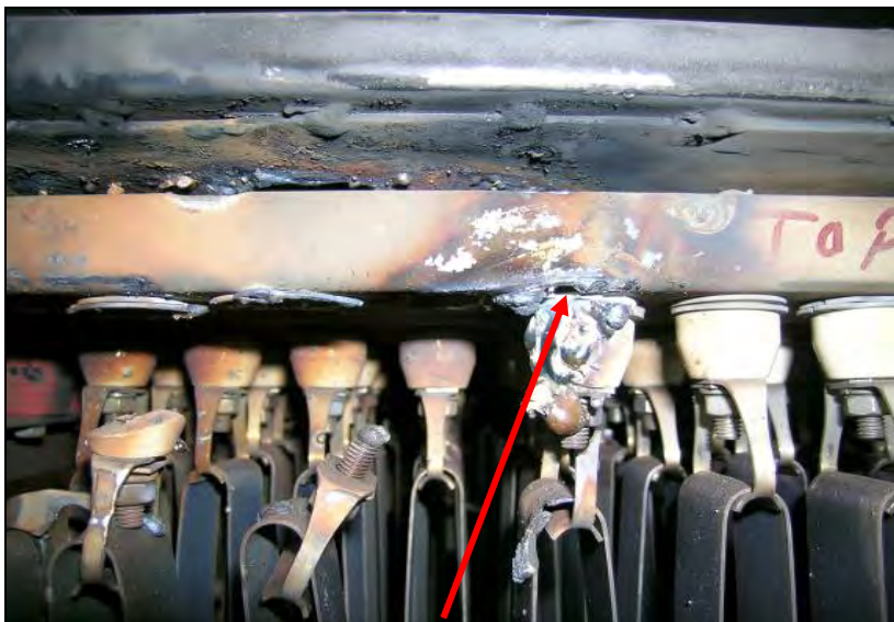
Figur 11: Bilde av kjørebremsekontakt etter lysbue.
