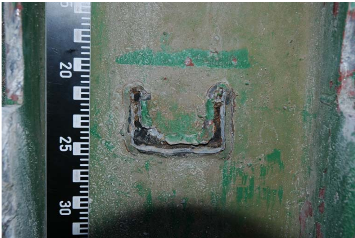
Fig. 8: Bildet viser bruddflater for sveisen i U-profilens ytterkanter (Kilde: Rogaland politidistrikt).
