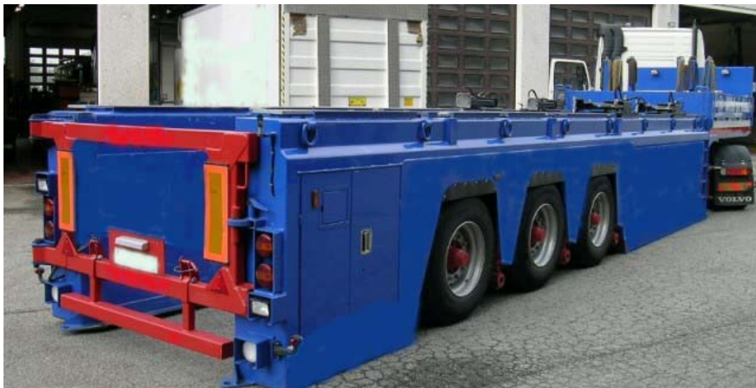
Fig. 11: Bildet viser eksempel på en av flere typer semitrailer med nedsenket lastbærer
