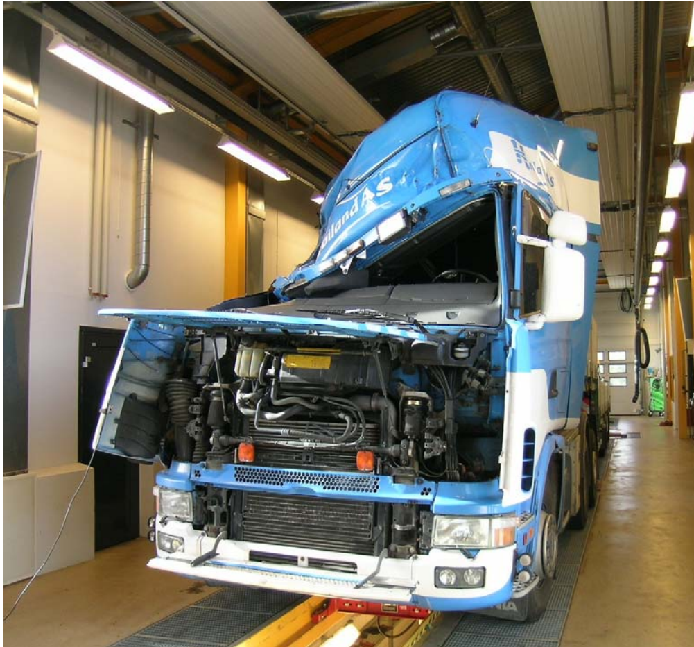
Fig. 4: Bildet viser skader på førerhus til trekkbilen som veltet ved Tengs
