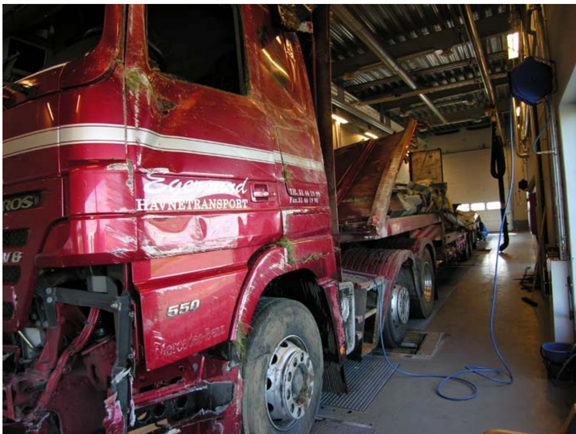
Fig. 5: Bildet viser skader på trekkbil og semitrailer som veltet ved Sirevåg
