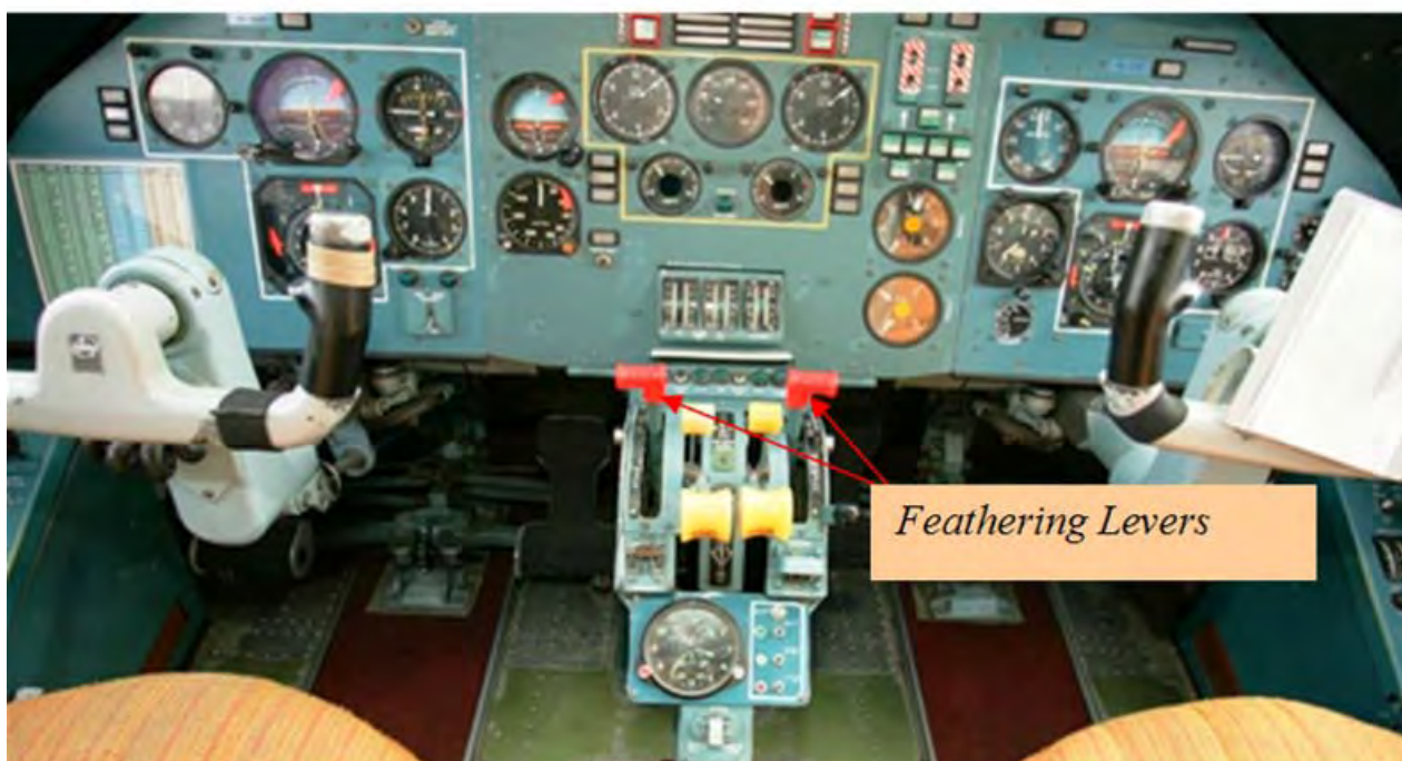
Figur 4: AN-28 Flight Deck med instrumentpanel, senterpanel og røde Feathering Levers.
